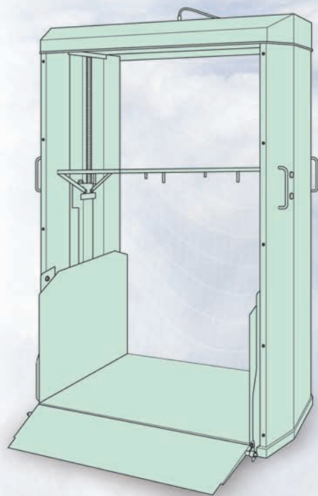
Position „Unten“: automatisch ausgefahrene Rampenbleche
